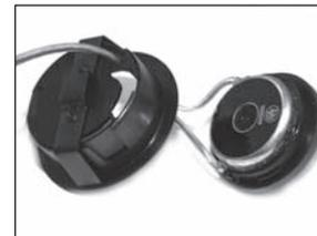
Вставьте излучатель твитера в чашку, пропустив провод в нижнее отверстие. Затем присоедините излучатель к чашке, повернув его по часовой стрелке. При снятии излучателя с чашки, поверните его против часовой стрелки и поднимите.
