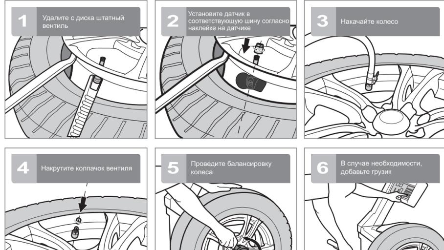
**Программирование нового датчика (датчики из комплекта запрограммированы)**
