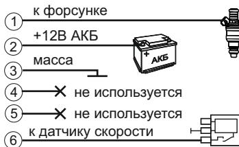
Во всех протоколах (кроме Универсального), подключение к форсунке и/или датчику скорости является опциональным - производится только в том случае, если ECU не выдаст данные по линии диагностики. В этом случае после подключения производится дополнительная настройка в Дисплее установок - Источники: Расход - Форс; Обороты - Форс; Скорость - ДС.
