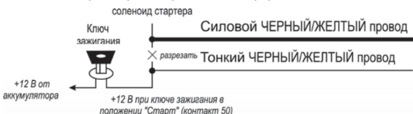
На автомобилях оборудованных кнопкой старт/стоп силовой ЧЕРНЫЙ/ЖЕЛТЫЙ провод необходимо подключить к цепи питания стоп-сигналов и произвести программирование соответствующей функции (функция 8 вариант 3 табл. 2)
