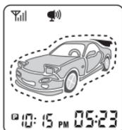
В случае преднамеренного или случайного открытия багажника на дисплее брелока будет мигать значок багажника.
