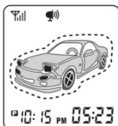
В случае дистанционного запуска двигателя или запуска с помощью ключа зажигания на дисплее брелока будут мигать значки габаритных огней и дисков колес.
