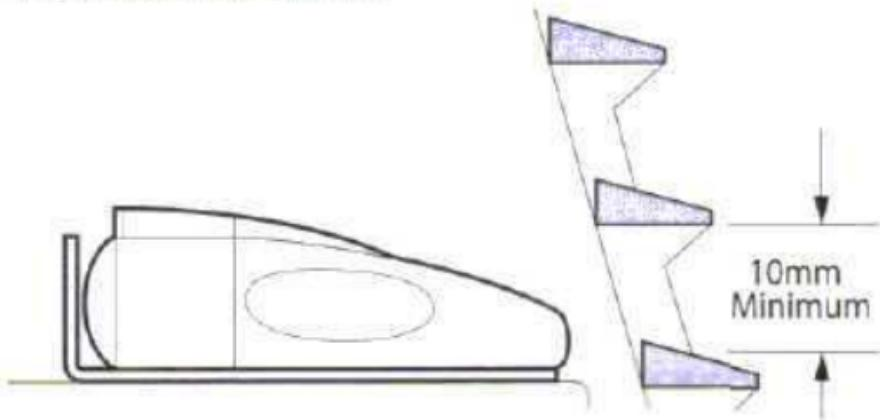
Когда Вы определили подходящее для установки место, используя L-образный кронштейн, просверлите выбранную поверхность 2 или 4 отверстиями, чтобы зафиксировать кронштейн, используя идущие в комплекте саморезы или болты.
