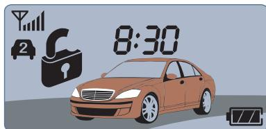
Показания индикатора изменяются только при получении сигнала обратной связи. Проверить наличие связи между процессорным блоком и брелоком можно коротким нажатием кнопки IV брелока-коммуникатора.
