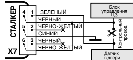
Рис. 8. Схема подключения к центральному замку, которому для отпирания требуется отрицательный импульс, а для запирания - разъединение проводов
