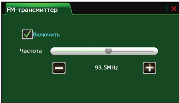
FM-трансмиттер посыпает аудиосигнал на автомагнитолу или другое радиоустройство с FM-диапазоном. Например, если выставить на Навигаторе частоту 93,5 МГц и принимающее устройство настроить на эту же частоту, то все звуковые сигналы Навигатора будут транслироваться через усилитель радиоустройства. Встроенный динамик Навигатора при этом отключается.
