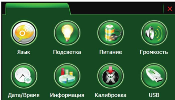
Доступны следующие опции: регулировка яркости подсветки, громкости, установка даты, времени и часового пояса, USB-соединения, информация о заряде аккумуляторной батареи, калибровка экрана, выбор языка интерфейса, сведения о системе.
