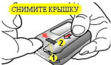
Для замены батареи питания откройте крышку батарейного отсека с обратной стороны пульта, как показано на рисунке – сначала сдвинув замок, а затем сдвинув крышку в сторону кольца для ключей. Выньте старый элемент, затем вставьте новый, соблюдая полярность подключения. Закройте крышку в обратной последовательности.
