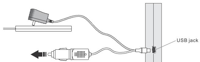
⚠ В автомобиле подключайте зарядное устройство только после запуска двигателя, что избежать возможного повреждения устройства из-за перепада напряжения, отсоедините после остановки.
