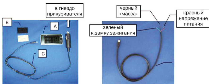
Рис. 3. Подсоединение дисплея к источнику питания.
