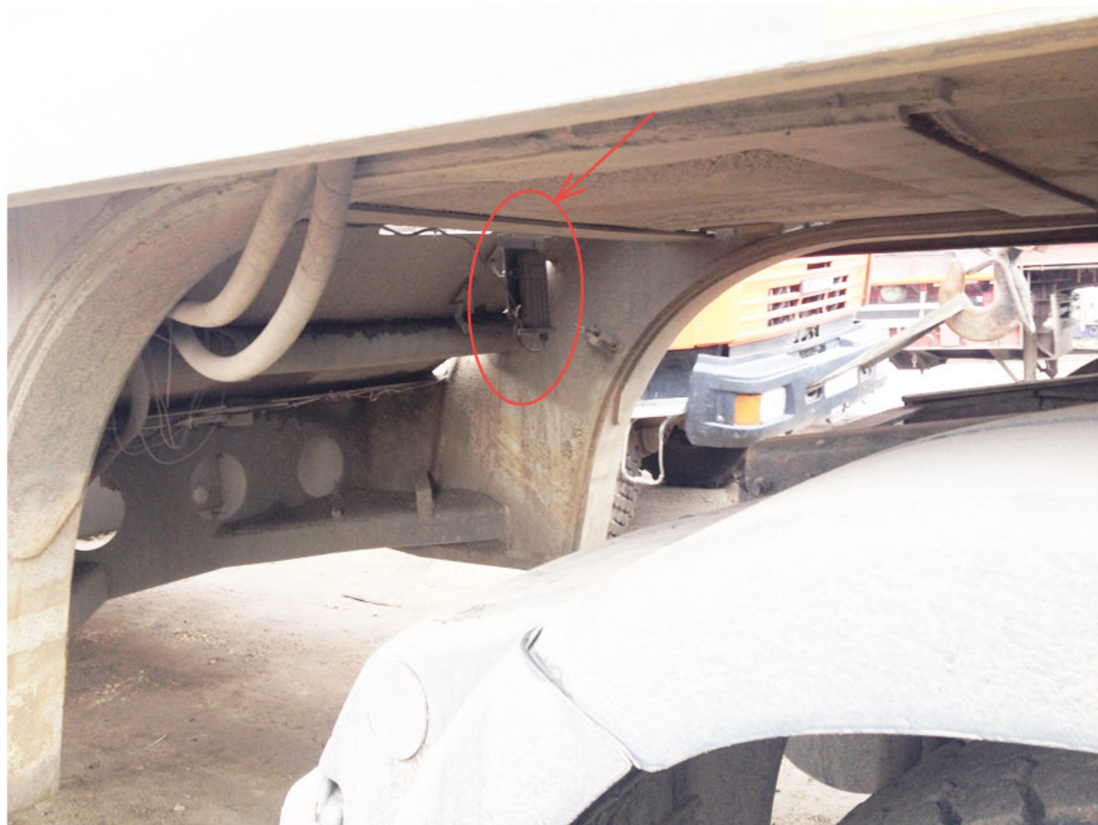
Пример НЕ ПРАВИЛЬНОЙ установки репитера
