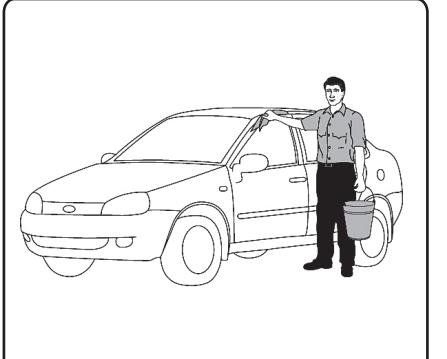
4. В местах установки опор багажника очистить крышу автомобиля от загрязнений.
