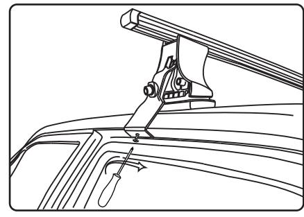
8. Если в дверных проемах (и, соответственно, в прижимах багажника) предусмотрены отверстия для крепления багажника, необходимо закрепить прижимы винтами, находящимися в комплекте поставки.
