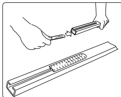
9. Вставьте линейку в прорезь поперечины закругленным концом вперёд и шкалой наружу.
