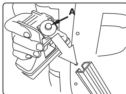
10. Вставьте опору в поперечину так, чтобы обойма с пружинными шайбами оказалась внутри поперечины, а квадратная шайба снаружи.
