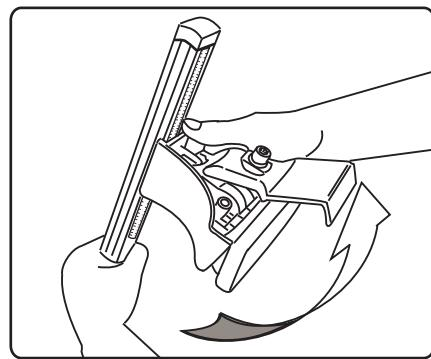
3. Опору багажника сместите в сторону центра дуги до упора в линейку. Поверните опору, тем самым зафиксировав ее на дуге.
