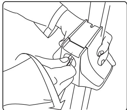
1. Если вы приобрели багажник в сборе, извлеките багажник из коробки, возмите ключ из комплекта. Поворотом ключа на угол  $\approx 90^\circ$  по часовой стрелке откройте замок.
