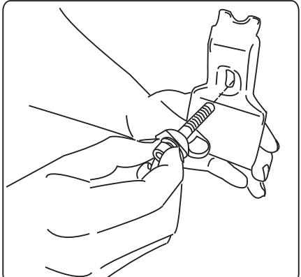
6. Выберите прижим на основании информации, указанной на наклейке, расположенной непосредственно на прижиме. Вставьте болт в паз прижима.
