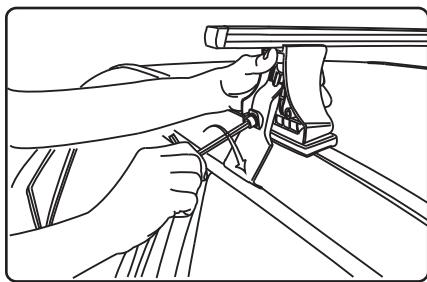
9. С помощью Г-образного ключа из комплекта затяните крепежные болты. Затягивание нужно производить попеременно с каждой стороны на 2-3 оборота. Окончание затягивания определяется по выпрямлению прямоугольных дуг либо началу изгиба аэродинамических дуг.
