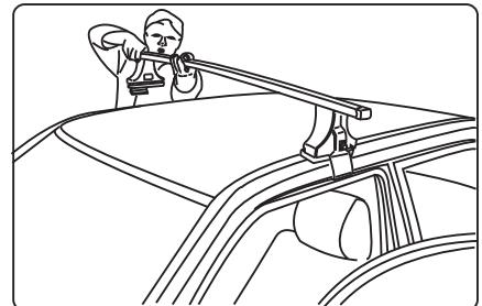
6. Руководствуясь этими наклейками, установите багажник в сборе на крышу автомобиля. Убедитесь в том, что багажник установлен на крыше ровно (проверьте спереди).
