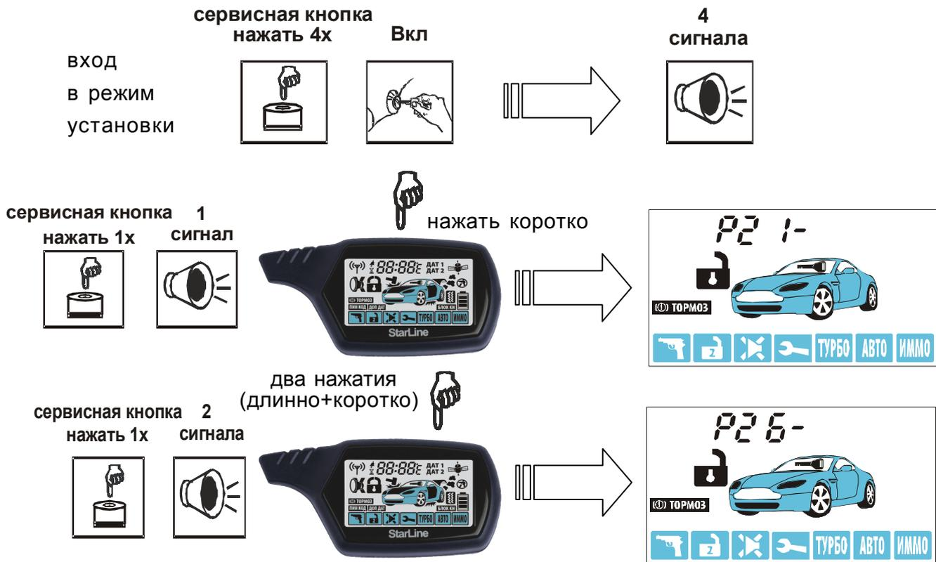
**Примечание.** На дисплее брелка обновляется только текущая цифра кода, остальные цифры соответствуют ранее установленному коду. В нашем примере предыдущий код имел значение 11, поэтому на первом шаге после установки первой цифры 2, на дисплее индицируется значение 21.
