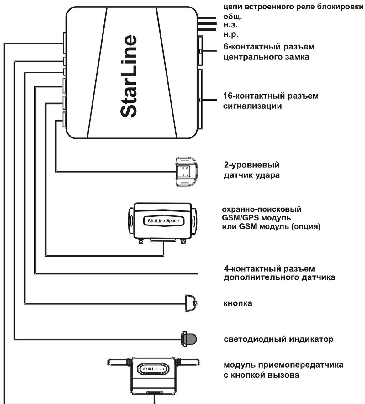
Подключение 16-контактного разъема
