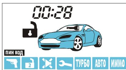
2. Войдите в режим установки ПИН-кода. При выключенном зажигании нажмите сервисную кнопку 4 раза. Каждое нажатие сопровождается загоранием светодиодного индикатора.
