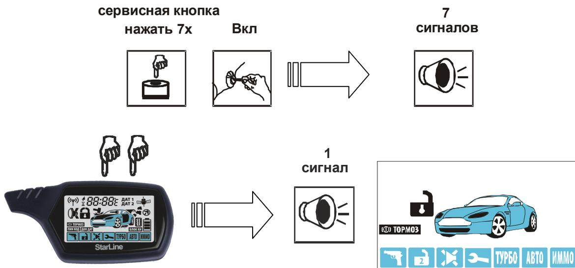
4. Повторите пункт 3 для всех записываемых брелков. Интервал между записью каждого брелка не должен превышать 5 секунд. Успешная запись каждого нового брелка подтверждается соответствующим количеством сигналов сирены.
