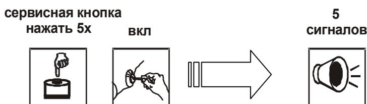
3. Нажимайте сервисную кнопку для продвижения по функциям от 1 до 14. Каждое нажатие сервисной кнопки выбирает очередную по номеру функцию. Номер выбранной функции отображается вспышками светодиода и сигналами сирены. Расшифровка сигналов сирены и вспышек приведена внизу в таблице. Также номер выбранной функции и ее значение отображаются на брелке с ЖК дисплеем.
