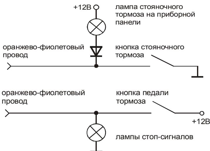
Подключение к выключателю стояночного тормоза, который замыкается на корпус при включении тормоза.
