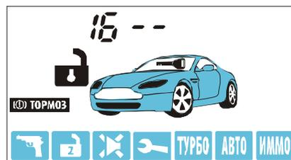
**вариант 4** - работа канала в режиме поддержки +12В на контакте IGN1 (15/1) замка зажигания при активизации режима охраны с работающим двигателем. Поддержка зажигания происходит автоматически при работающем двигателе (или включенном зажигании) при затягивании ручного тормоза. Время нахождения в режиме поддержки зажигания не ограничено. Поддержка будет выключена при выключении зажигания или при отпускании ручного тормоза.
