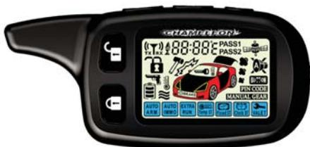
Двусторонний пульт представляет собой миниатюрное приемо-передающее устройство с питанием от 1,5 вольтовой батарейки (тип LR03 AAA), которой, в зависимости от интенсивности использования пульта, хватает на срок от 1 до 6 месяцев. При установке свежей батареи индикатор её заряда
