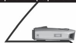
Необходимо обеспечить отсутствие препятствий перед объективом устройства, а также свободный обзор заднего стекла из местоположения линзы LaserEye для обнаружения с охватом 360°.
