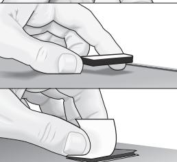
4. Прикрепите детектор к крепежной пластине с лентой Велькро. Устройство можно снимать и снова прикреплять без ограничений.
