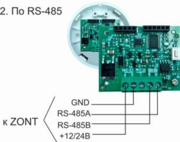
Максимальная длина линии **RS-485** не более 200 м. При больших длинах рекомендуется устанавливать дополнительные резисторы 120 Ом между клеммами А и В с обоих концов линии и использовать кабель UTP (витую пару) CAT5.
