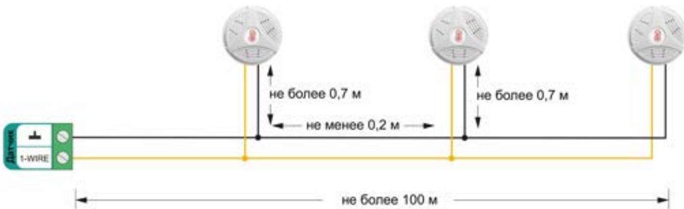
Подключение датчиков по трехпроводной схеме:
