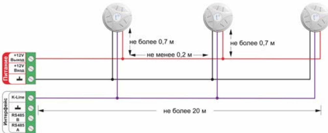
**2. Подключение цифровых датчиков температуры к шине 1-wire**
