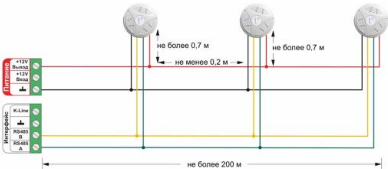
**Подключение нескольких датчиков по K-Line:**
