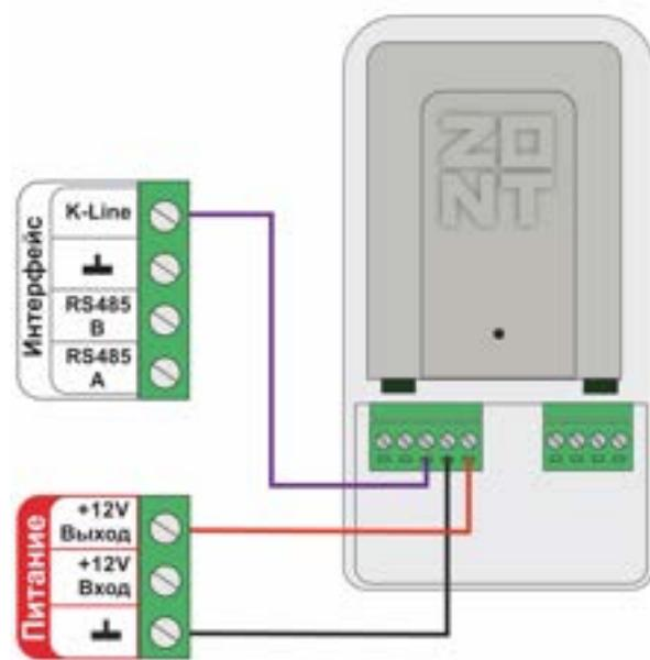
Схема подключения внешнего адаптера цифровой шины **DIN** по **RS-485**:
