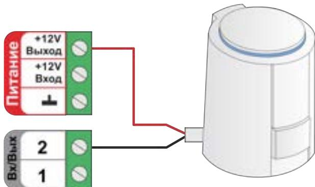
Схема подключения исполнительного устройства к релейному выходу:
