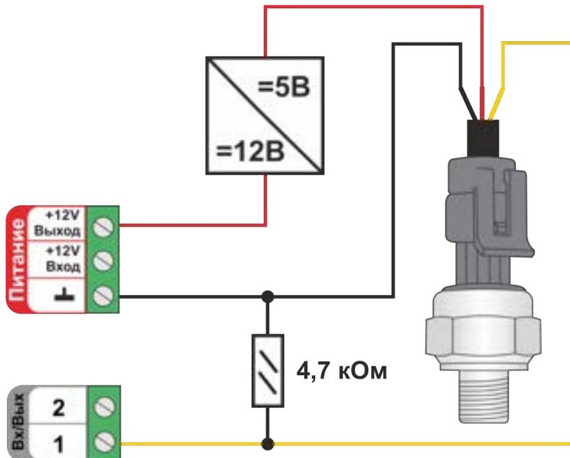
**Примечание:** Для формирования сигнала “обрыв датчика” необходимо установить резистор подтяжки – между аналоговым входом и общим проводом номиналом 4,7 кОм.
