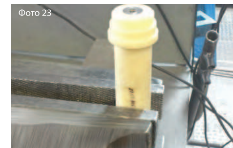
Фото 23 3.20. Установите приспособление для сверлений в слесарные тиски (Фото №23).
