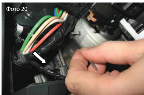
Фото 20 3.17. Затяните винт М5, для устранения люфта между «Защитой корпуса» и рулевым валом (Фото №20).
