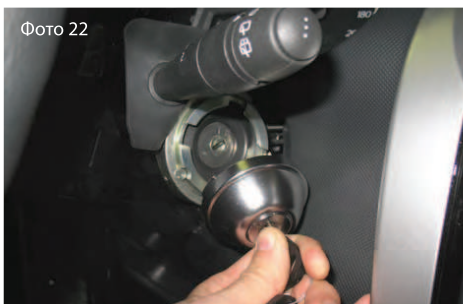
Фото 22 3.19. Установите «Защиту личинки» на фланец «Защиты корпуса». Подключите массовую клемму аккумулятора. Произведите проверку работоспособности устройства «Гарант Panzer» и штатного замка зажигания автомобиля. А так же всего электрооборудования автомобиля, в том числе и штатного иммобилайзера (Фото №22).
