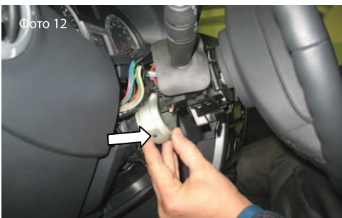
Фото 12 3.9. Закрутите винт М5 с использованием анаэробного герметика (типа Loctite 243) в хомут замка и установите хомут на рулевой вал (Фото №12).
