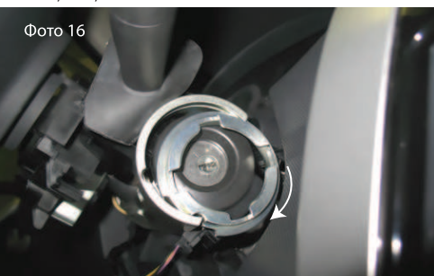
Фото 16 3.13. Совместите отверстие в фланце и верхнюю часть корпуса. Сориентируйте фланец в канавке корпуса. Заведите фланец в канавку корпуса, провернув его по часовой стрелке (Фото №16).
