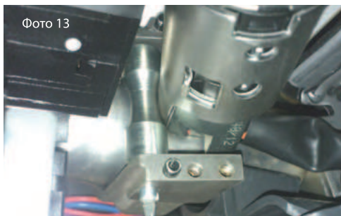
Фото 13 3.10. В хомут, установите втулку, закрепив ее осью фиксирующей, предварительно нанеся анаэробный герметик (типа Loctite 243). (Фото №13)
