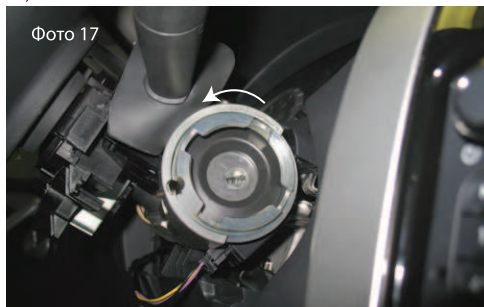
Фото 17 3.14. Проверните фланец в корпусе против часовой стрелки до совмещения отверстия в фланце и корпусе (Фото №17).
