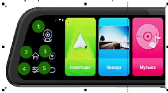
В левой части экрана горячие клавиши управления видеорегистратором.
