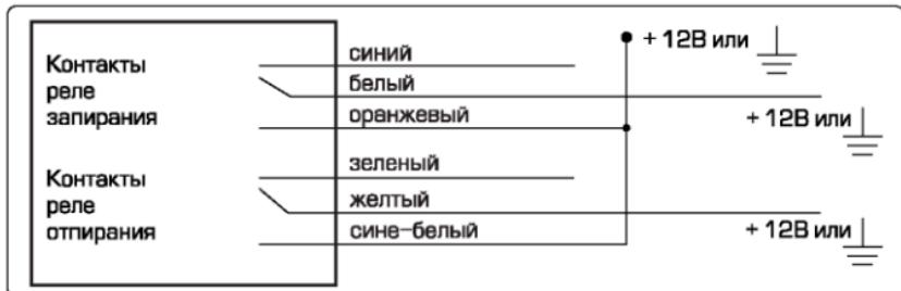
Схема подключения к двухпроводным приводам системы запирания
