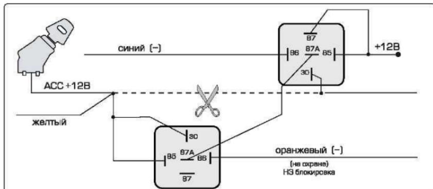
Схема подключения к соленоиду замка багажника с отрицательной полярностью
