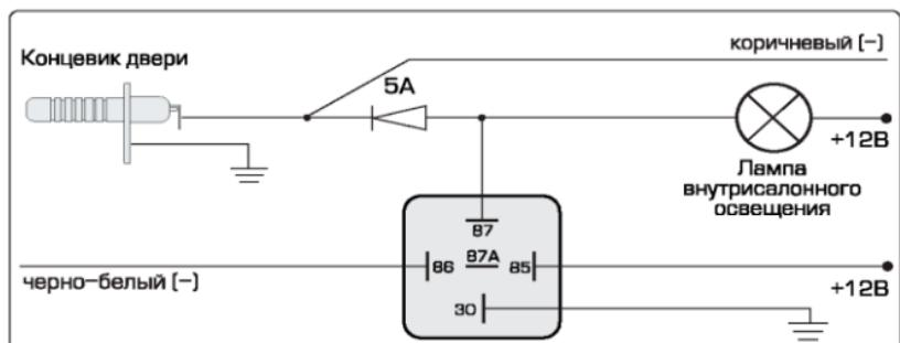
Схема подключения внутри салонного освещения с положительной полярностью
