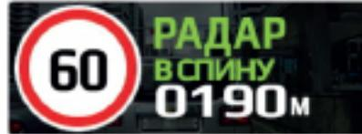
Где верхняя строка демонстрирует тип камеры/радара: РАДАР, КАМЕРА, СТРЕЛКА, АВТОДОРИЯ, ПОТОК, МУЛЯЖ;
