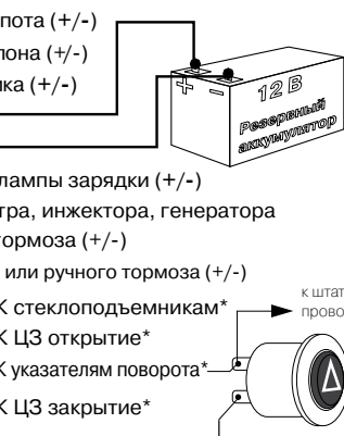
Схема релейного модуля автозапуска
