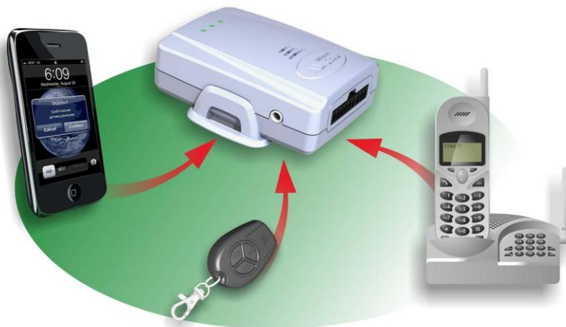
Контрольная панель является центральным компонентом устанавливаемого на объекте охранного оборудования. К ней подключаются по проводным или беспроводным каналам связи все остальные компоненты охранной сигнализации. Сама контрольная панель в свою очередь по GSM каналу осуществляет информирование владельца или мониторингового центра о состоянии режима охраны объекта и передает команды управления исполнительным устройствам.
