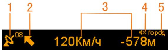
1. Текущее количество спутников GPS, если GPS не может устанавливать связь, то на дисплее отображается следующе значки -> -> видеорегистратор пытается установить связь со спутниками.
