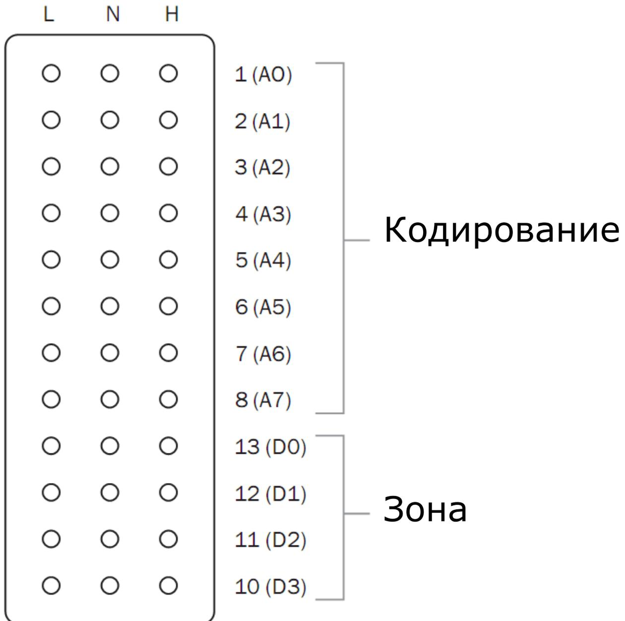
Для того чтобы датчик работал с Вашим центральным блоком, необходимо установить именно его кодирование. Кодовая комбинация центрального блока указана на задней стороне центрального блока напротив надписи «Кодирование».
