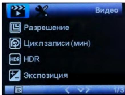
Подраздел “Разрешение” позволяет выбрать один из четырех значений качества видеозаписи - разрешение Full HD, HD, WVGA,VGA .
