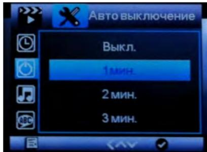
В режиме видеозаписи выключение не происходит. При необходимости отключить экран во время записи видео без прерывания цикла записи и с помощью нажатия одной кнопки, можно, нажать кнопку “включения/выключения”.
