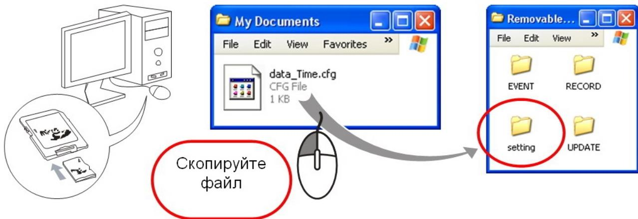
4) После вставки SD-КАРТЫ в устройство, включите переключатель питания. И Время на устройстве автоматически будет установлено на время из файла [data\_Time.cfg]. И файл автоматически будет удален.
