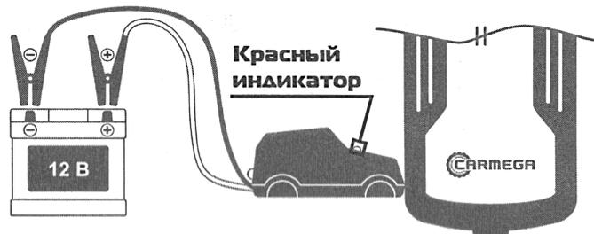
*В этом случае нажмите кнопку принудительного запуска на блоке силовых клемм и дождитесь зеленого свечения индикатора силовых клемм. Затем в течение 30 секунд осуществите запуск двигателя.*
