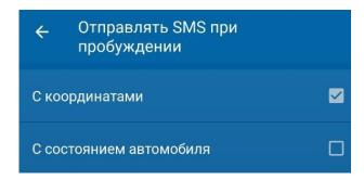
Если установлена одна из настроек "Отправлять СМС при пробуждении", то при каждом пробуждении устройства отправляет СМС с координатами или состоянием, или и тем и другим на телефон M1.
