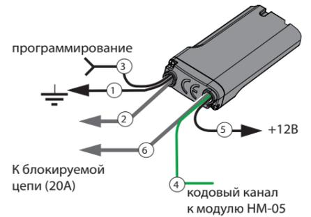
Провод «1» (Черный) реле блокировки должен быть присоединен к кузову автомобиля или надежному проводнику, соединяющему кузов и какой-либо штатный потребитель. Данный провод подсоединяется при монтаже в первую очередь.
