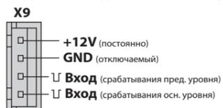
Входы обрабатывают импульсы отрицательной полярности длительностью не менее 0,3 сек.
