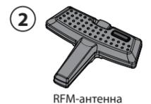
Рекомендуется располагать RF-модуль на лобовом стекле. При этом обеспечьте расстояние от металлических частей кузова до RFM-антенны не менее 7 см. Учтите, что наличие встроенного обогрева лобового стекла может снизить дальность работы радиоканала.
