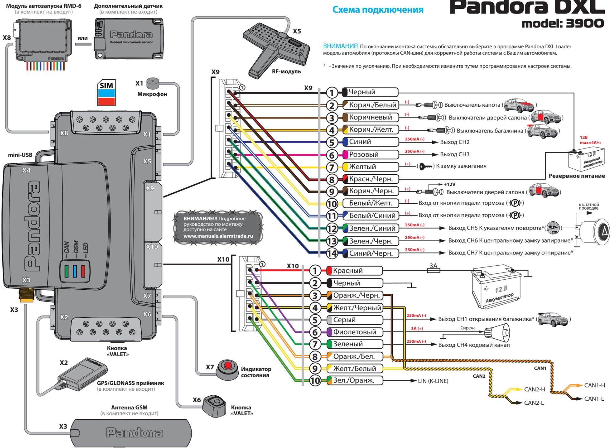
**ВНИМАНИЕ!** По окончании монтажа системы обязательно выберите в программе Pandora DXL Loader модель автомобиля (протоколы CAN-шин) для корректной работы системы с Вашим автомобилем.
