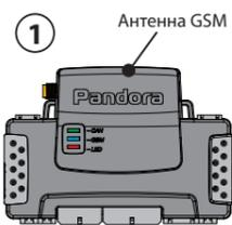
Рекомендуется располагать базовый блок системы под «торпедой» или в районе приборной панели разъемами вниз. При этом обеспечьте жесткое крепление к кузову автомобиля или деталям непосредственно связанным с кузовом. Встроенная GSM-антенна не должна экранироваться металлическими элементами конструкции автомобиля. В случае если место установки не обеспечивает устойчивого приема сигнала сотовой сети, необходимо использовать внешнюю GSM-антенну (в комплект не входит).
