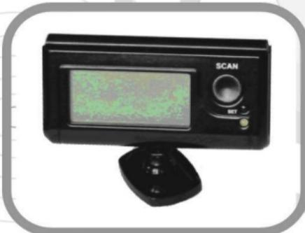
После установки дисплея его следует подключить к бортовой сети. Белый провод присоединяется к плюсу замка зажигания, красный провод к плюсу аккумулятора, черный на корпус.
