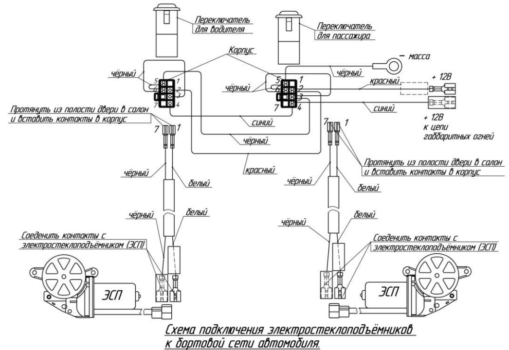
*Схема подключения электростеклоподъёмников к бортовой сети автомобиля.*
