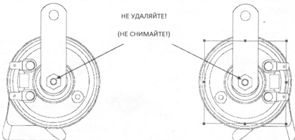
Не трогайте гайки и центральный болт, так как это может привести к поломкам, а также к неисправной работе сигналов
