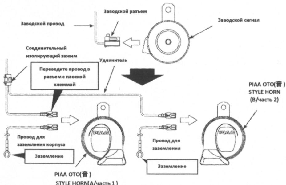
**D. Установлен 1 заводской сигнал. Сигнал имеет 2 разъема.**
