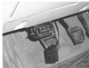
4. Соединить с помощью соответствующих разъемов компьютер с расширителем сигналов, а его, в свою очередь, с диагностическим разъемом OBD-II.
