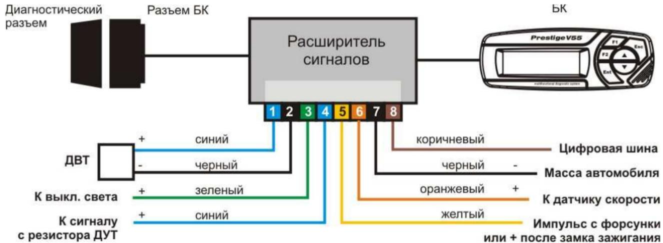
**Датчик внешней температуры** рекомендуется устанавливать внутри переднего бампера а/м в месте, защищенном от попадания грязи, воды, снега и прямого воздействия воздушного потока. Для нормальной работы необходимо максимально изолировать датчик от потока воздуха, нагретого двигателем. После установки ДВТ требует обязательной коррекции показаний с текущей температурой воздуха (см. стр. 50).
