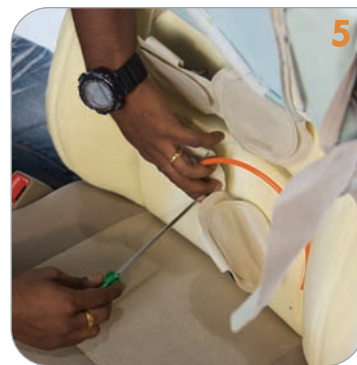
5 Проташите крепежные стяжки через отверстия
