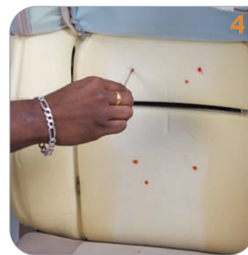
4 Проколите отверстие крепежных стяжек
