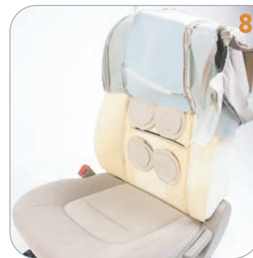
8 Проверьте качество установки подушек
