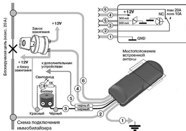
При монтаже, для усложнения локализации расположения модуля блокировки потенциальным злоумышленником, допускается не использовать входящий в комплект биппер. Но, в этом случае, необходимо предупредить владельца о возможных проблемах, связанных с отсутствием этого средства извещения и диагностики.
