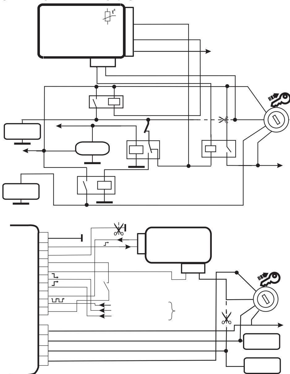
Оранжевый провод (вход X4/12 - замок зажигания) комплекса должен быть подключен таким образом, чтобы на нем появлялись +12В, когда ключ в замке зажигания повернут в положение «зажигание» и «стартер», и пропадали в положении ключа «выключено».
