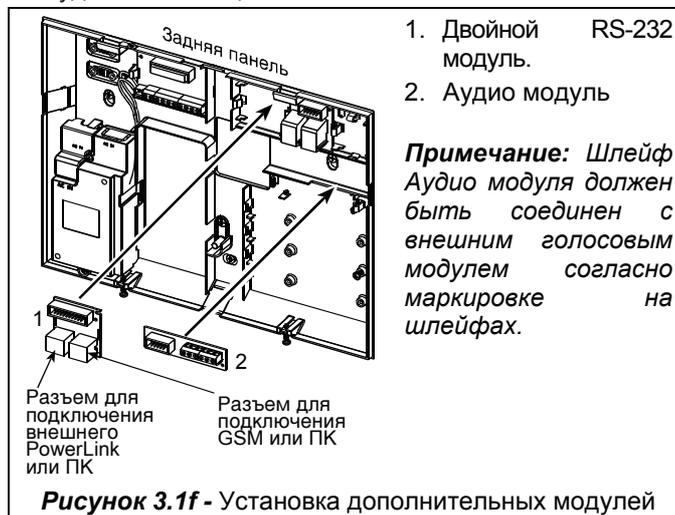
Рисунок 3.1f - Установка дополнительных модулей
