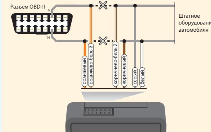
2. Для автомобиля с двумя шинами CAN, одна из которых однопроводная
