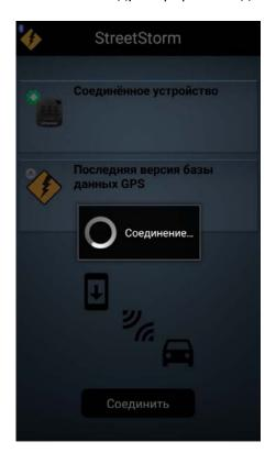
8. После установления связи программа покажет название детектора, версию его прошивки и информацию о базе. Для обновления базы данных нажимаем кнопку загрузки **\$\Psi\$**:
