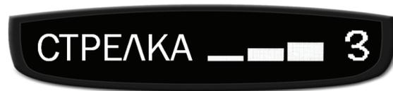
На дисплей выводится обозначение радарного комплекса Стрелка и уровень сигнала от 1 до 3, в графическом и цифровом виде.
