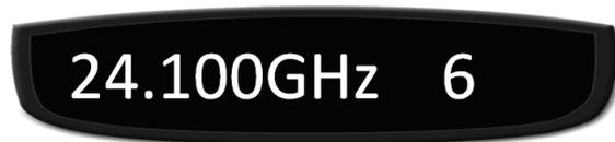
2. Второе долгое нажатие отключает режим отображения частоты, на дисплей выводится сообщение:
