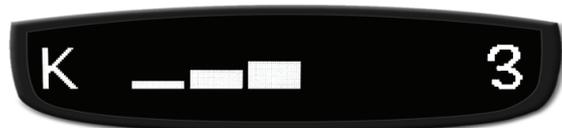
При обнаружении радарного сигнала в диапазонах **X** или **Ka** звучит прерывистый звуковой сигнал, интенсивность которого повышается по мере увеличения уровня сигнала радара. Звуковой сигнал можно отключить коротким нажатием кнопки **MUTE**.
