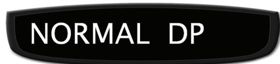
В этом режиме (заводская установка) при обнаружении сигнала радара на дисплей после названия диапазона будут выведены графический и цифровой индикаторы уровня обнаруженного сигнала.
