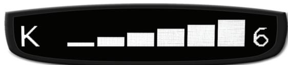
На рисунке: Информация на дисплее при обнаружении очень сильного сигнала радара, работающего в диапазоне **K**:
