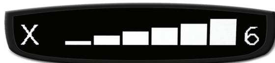
На рисунке: Информация на дисплее при обнаружении очень сильного сигнала радара, работающего в диапазоне **Ka**:
