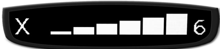
Пример: Информация на дисплее при обнаружении среднего уровня сигнала радара, работающего в диапазоне **Ка**:
