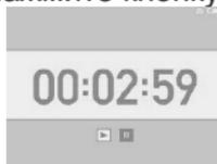
Для включения секундомера коротким нажатием переведите переключатель включения/выключения питания плеера вниз и сразу же отпустите его. Для паузы/возобновления отсчета коротким нажатием переведите переключатель включения/выключения питания плеера вниз еще раз.
