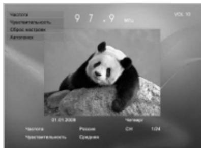
Для выбора частотного диапазона радиоприемника кнопками выберите “Частота” и нажмите кнопку .
