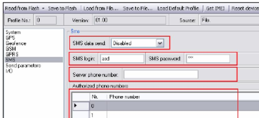
Рисунок 24. Конфигурация СМС логина, пароля, телефонного номера сервера и разрешенного телефонного номера
