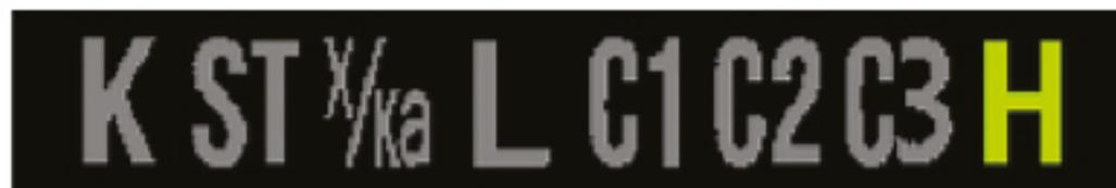
Отрегулируйте яркость дисплея кратковременными нажатиями клавиши **DIM** в зависимости от текущей освещенности/времени суток: «День» / «Ночь» / «Темный режим». «Темный режим» обладает той же яркостью, что и «Ночь», но не демонстрирует на экране сработавший диапазон, звучит только голосовое оповещение.
