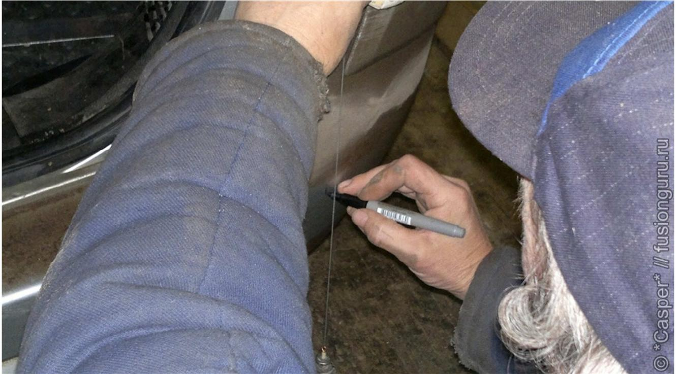
2. Используя фрезу из комплекта и дрель из домашнего запаса, делаем 4 отверстия в бампере. Я бампер не снимал, тк для его крепления используются одноразовые заклепки. Будет чуть сложнее, чем на снятом, но ничего. Центральные отверстия проделывал сразу в бампере и усилителе. Усилитель там пластиковый. Внимание. Возможно мне попалась бракованная фреза, она плохо резала пластик и старалась его плавить. Так что будьте аккуратны.
